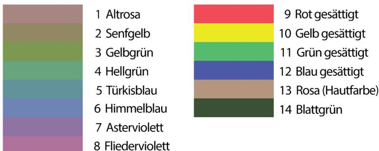
Der Nachteil der momentan geltenden Bestimmung für den Farbwiedergabe-Index liegt in der geringen Anzahl von 8 Testfarben. Eine neue Version wird zurzeit international überprüft. Sie besteht aus 99 Testfarben und ist unter der Bezeichnung „TM30-15“ bekannt.
