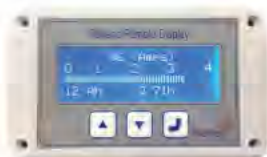
Maße: 125 x 60 mm Ausschnitt 130 x 80 mm Blende Gewicht: 0,184 kg
